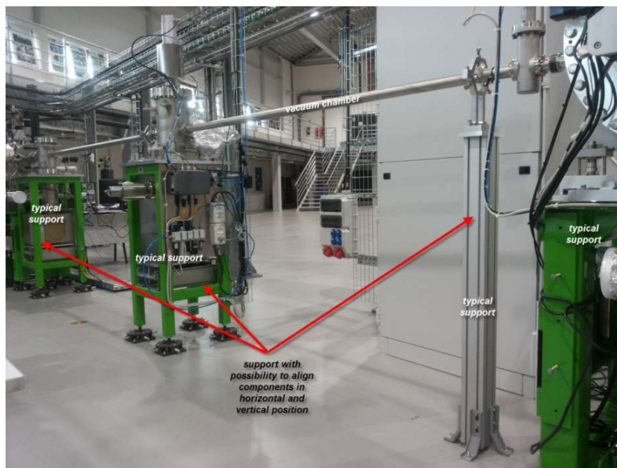
Rys. 3. Przykładowy system wsparcia komór próżniowych przy wykorzystaniu metalowych podpór.
